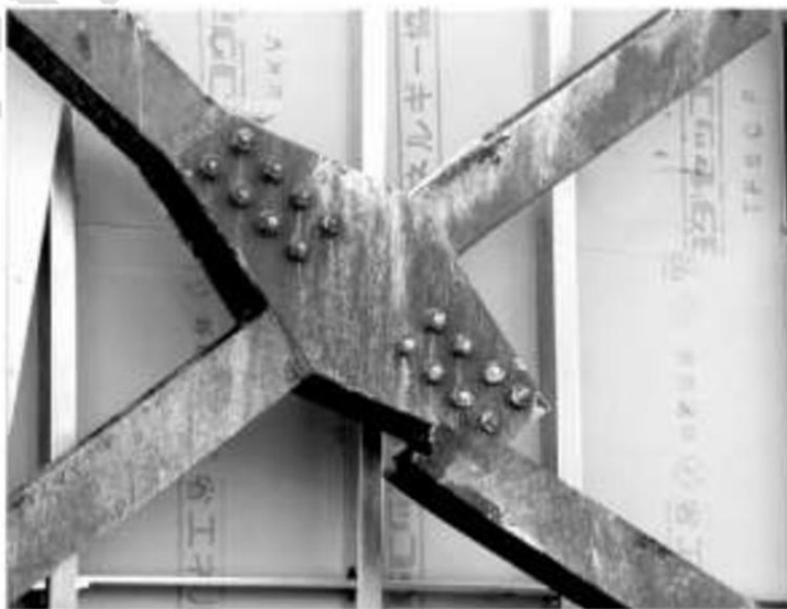
شکل ۳-۲ ترد شکنی در اتصالات پیچی
