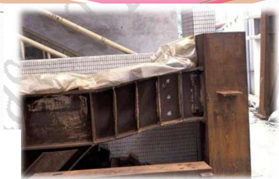
شکل ۶-۶ نمونه ای از رفتار تیر پیوند پس از بارگذاری [12]
